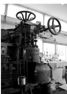
缶詰に蓋する「巻締」。委託加工もしている。
