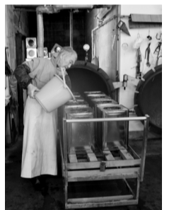
フキの詰まった一斗缶を大きな釜に入れ、圧力をかける。
